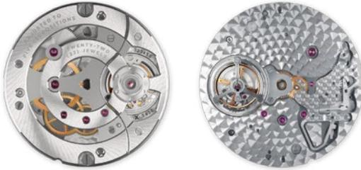
Dernier né de la lignée des extra-plats dans une version manuelle. Le Seed VMF 5430 – dont il faut souligner la robustesse du mécanisme – est augmenté d'un tourbillon volant à 9h dans une cage en titane pour de meilleures performances de réglage. Il s'agit de l'un des tourbillons les plus plats du monde qui reprend tous les avantages de la lignée des extra-plats. Son design offre de grandes possibilités de personnalisation des ponts et de la cage de tourbillon.
